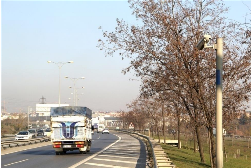
Şekil 4.21: Emniyet Şeridi İhlal Tespit Sistemi, 2013
