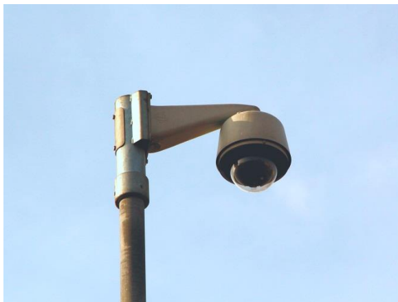
Şekil 4.16: Trafik Gözlem Kamerası, 2013
