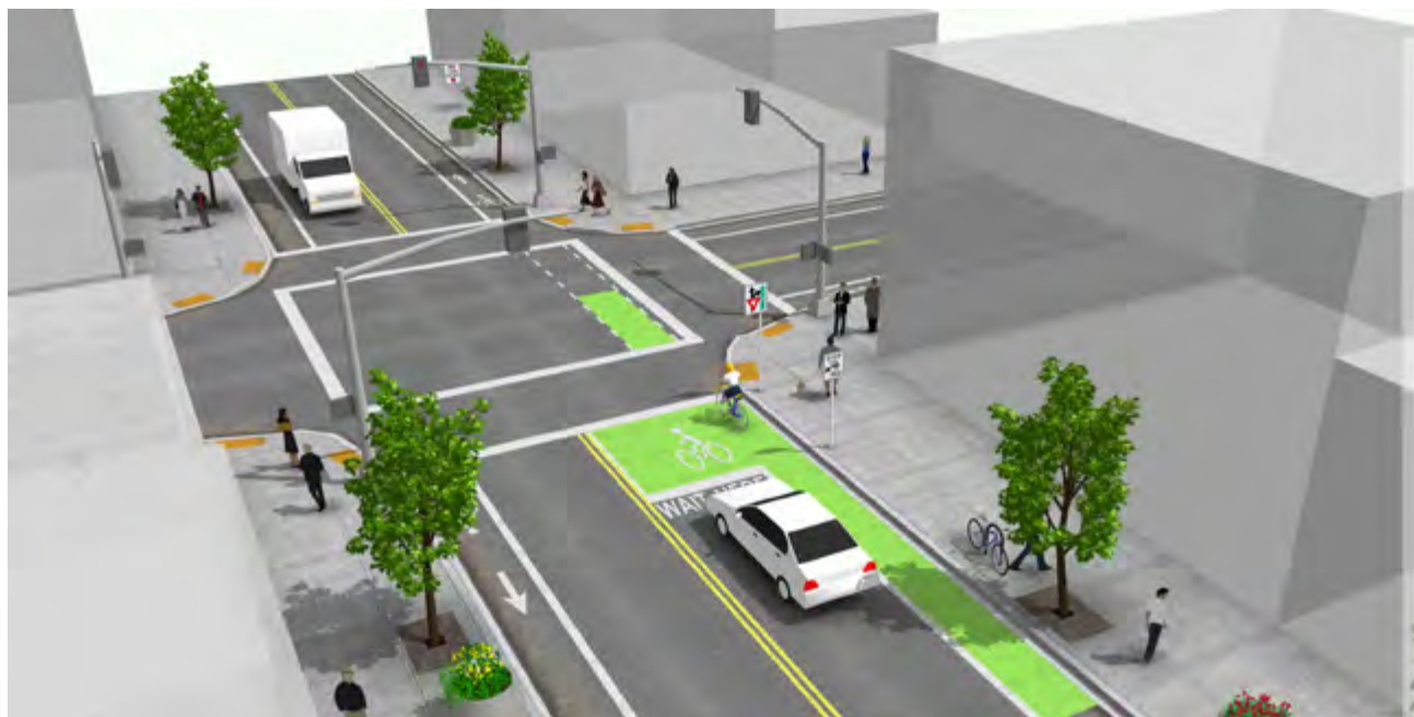
Şekil 72: Sinyalize kavşakta bisiklet bekleme alanı tasarımı
