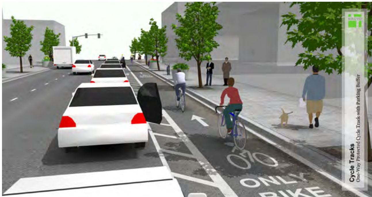
Şekil 62: Araç Park Yeri ile Korunan Tek Yönlü Ayırıcılı Bisiklet Yolu
