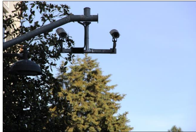
Şekil 4.23: Ters Yön İhlal Tespit Sistemi, 2013
