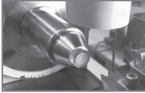
Resim 2.25. Torna kesme yöntemi ile kontak lens üretimi
