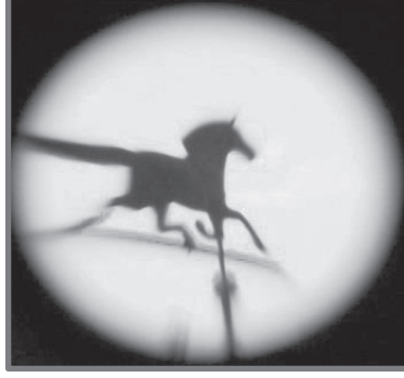
Resim 1.7. Abbe değeri düşük bir mercede oluşan gökkuşağı oluşumları
