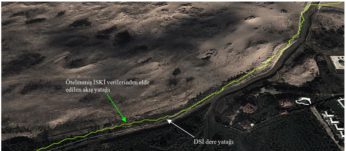
Şekil 6.5 : DSİ ölçülmüş dere yatağı ve nümerik olarak elde edilen dere yatağı arasındaki fark
